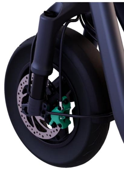
1. Bewege den Schutzblechbügel nun wieder an die Ausgangsposition und schraube diesen mit den beiden Innensechskantschrauben (ISK 4) mit ca. 5 – 7 Nm an die Federgabel vorne fest.
