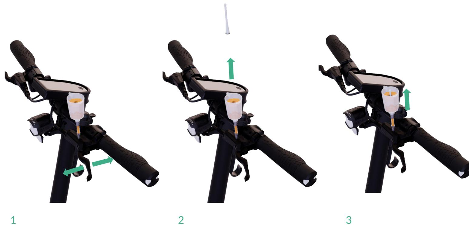
1. Bevor du den Trichter wieder entfernst, betätige den Bremshebel **mindestens sieben Mal** (siehe Bild 1), um verbleibende Restluft aus dem System zu entfernen und sicherzustellen, dass das System vollständig entlüftet ist.
