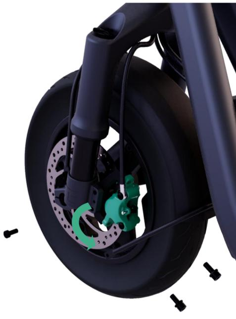
1. Löse die insgesamt vier Innensechskantschrauben (ISK 4). Zwei davon befestigen den Schutzblechbügel vorne beidseitig an der Federgabel und die anderen beiden befestigen den vorderen Bremssattel am Bremssattelhalter (siehe Bild 1 und Bild 2).
